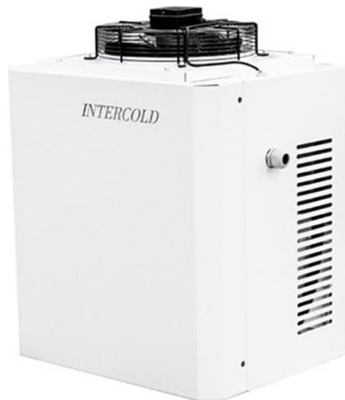
Среднетемпературная сплит-система Intercold MCM 342 PR FT предназначена для охлаждения и поддержания необходимого температурного режима во внутреннем объеме холодильных камер на предприятиях пищевой промышленности. Модель оснащена внешним блоком с установленным компрессором, пластинчато-трубчатый конденсатором, щитом управления с контроллером и силовой частью. Корпус выполнен из окрашенной оцинкованной стали, воздухоохладитель - из алюминия.
